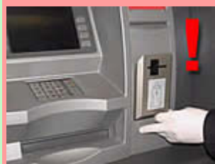
Okienko wrzutowe z założonym dodatkowym czytnikiem kart
