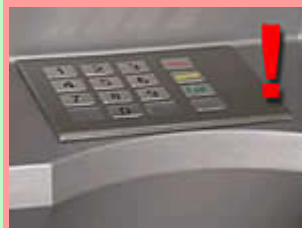
Klawiatura z założoną nakładką
